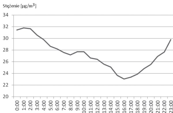
Ryc. 3. Dobowy przebieg stężenia PM10 w Koninie w latach 2012–2016 Fig. 3. The daily course of the PM10 concentration in Konin in 2012–2016
