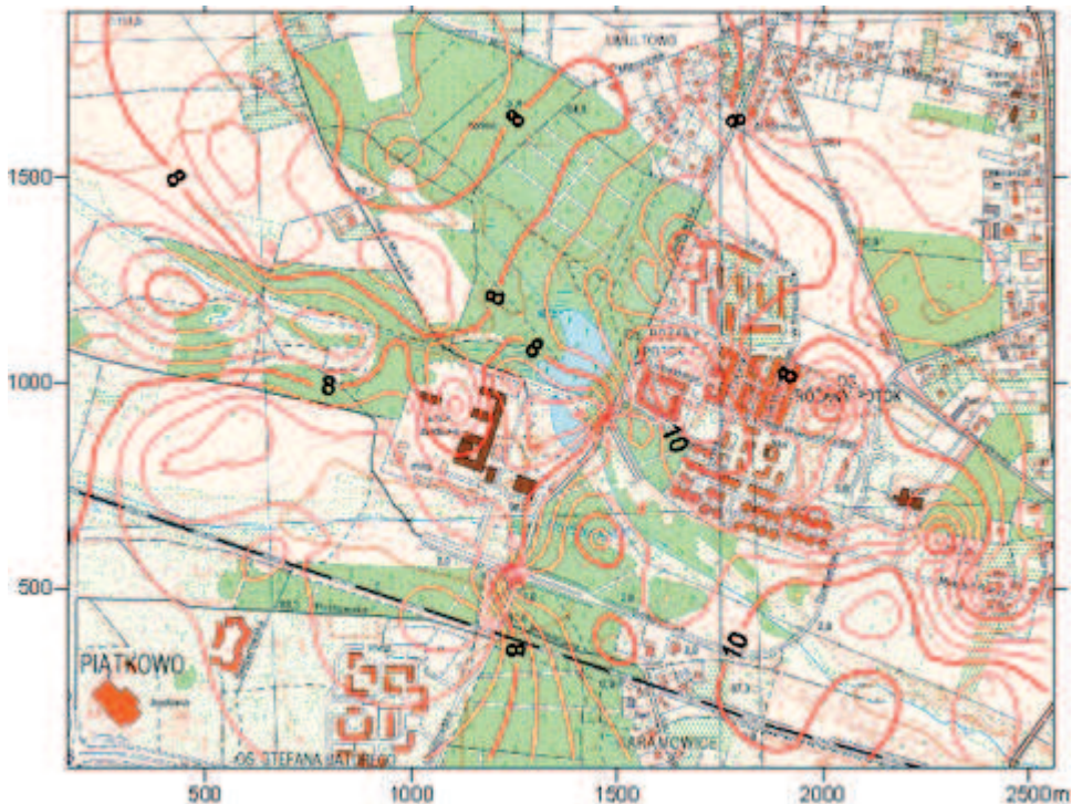
Ryc. 4. Rozkład temperatur na wysokości 150 cm nad poziomem gruntu
